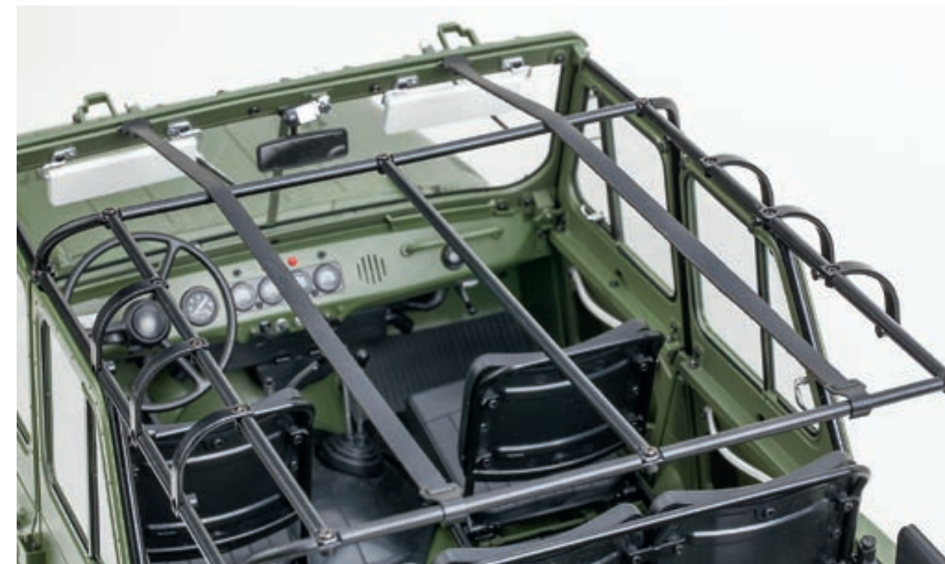
Шаг 4. Для завершения монтажа закрепите малые крепежные скобы натяжных ремней дуг тента в петлях рамки ветрового окна. Более широкие крепежные скобы ремней зафиксируйте на верхней трубе задней дуги тента.
