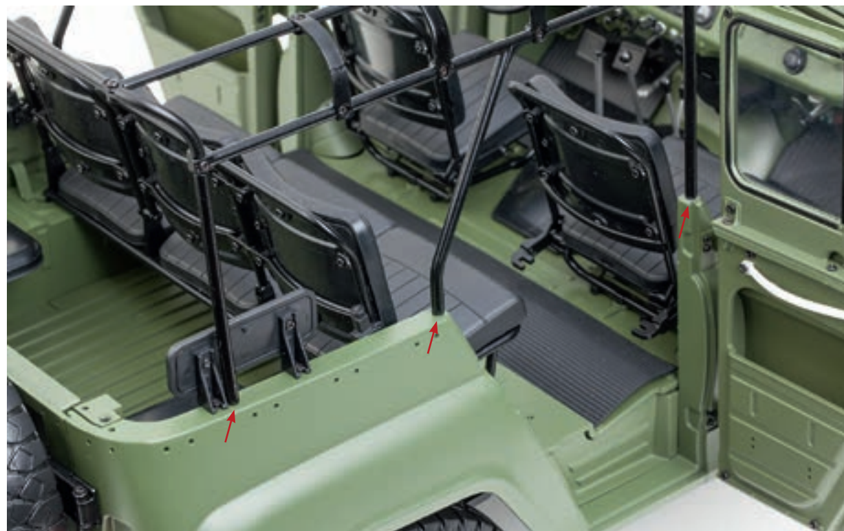
Шаг 3. Аналогичным образом зафиксируйте дуги каркаса в трех точках на втором борту кузова.
