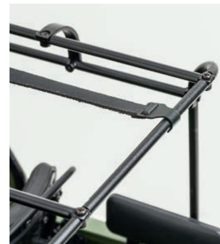
Шаг 4. Для завершения монтажа закрепите малые крепежные скобы натяжных ремней дуг тента в петлях рамки ветрового окна. Более широкие крепежные скобы ремней зафиксируйте на верхней трубе задней дуги тента.
